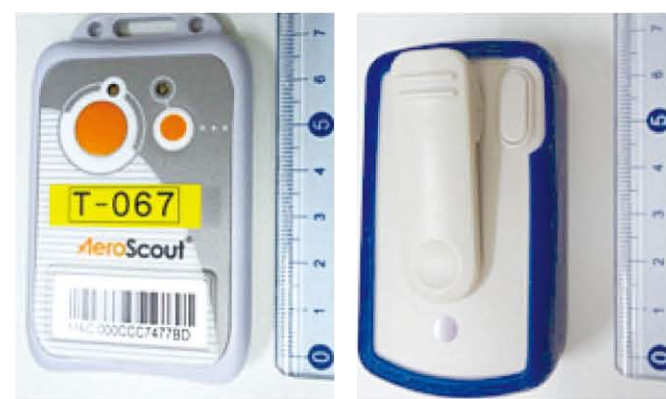
作業員が付ける姿勢検知機能付き無線式線量計(右)と位置検知タグ(左)。
